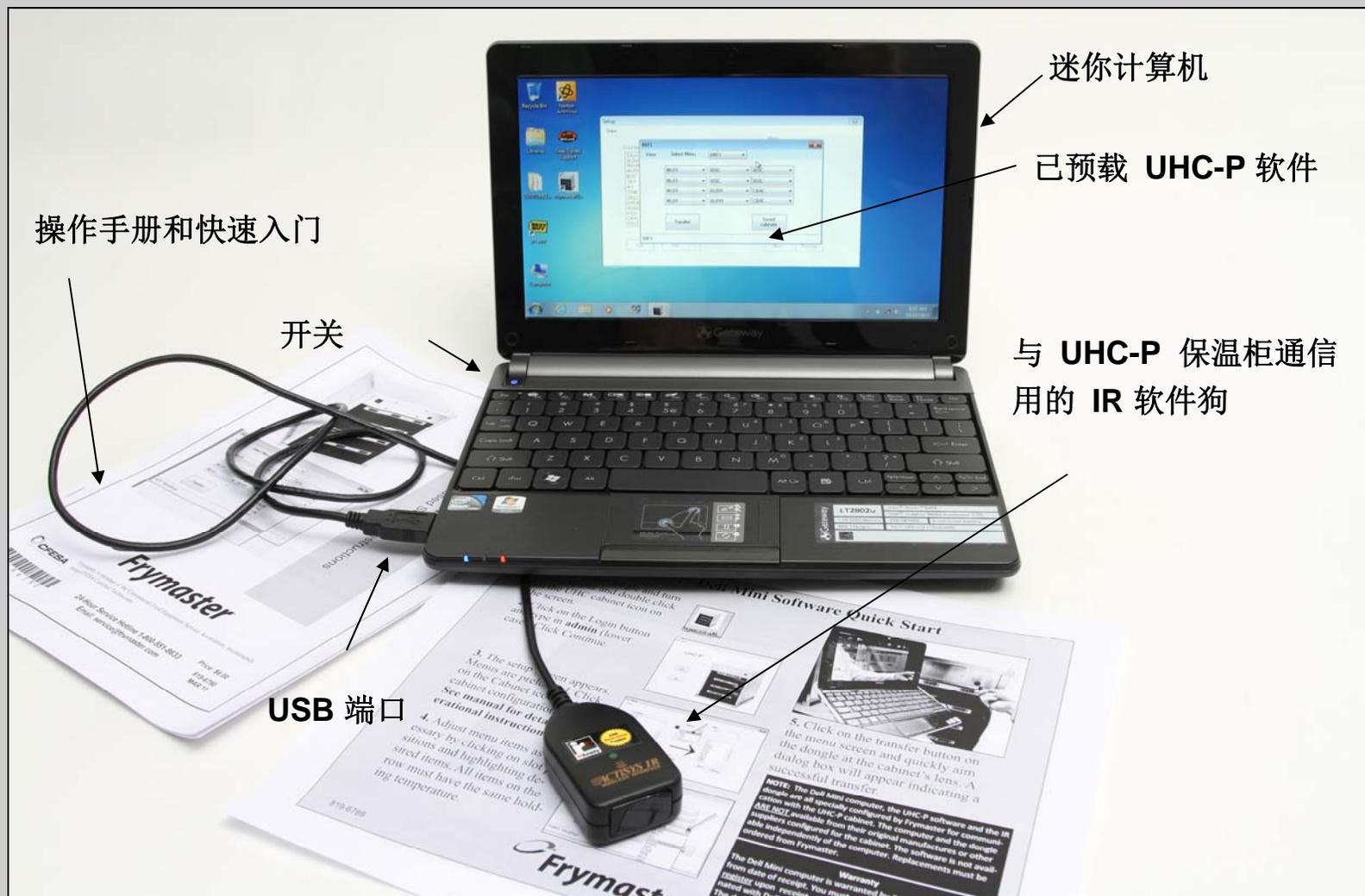
该计算机和 IR 软件狗经过 Frymaster 专门配置，可以与 UHC-P 保温柜通信。只有 Frymaster 能提供这些特别配置项。在操作方面，该基于迷你计算机的软件与 2006-2010 年使用的 Palm 掌上电脑计划相同。
