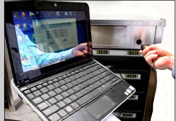
5. 在菜单屏幕上单击传输按钮并迅速将软件狗对准保温柜透镜。将出现一个对话框，指示传输成功。
